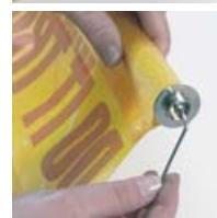
inserite barra nell'orlo del tessuto e avvitate l'occhiello sul cilindro
